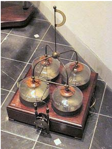
Vier Leidse flessen in Museum Boerhaave, Leiden . De Leidse fles was de eerste praktische condensator.
